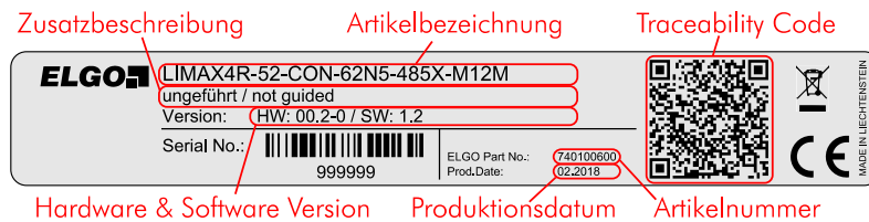
Abbildung 3: Typenschild zur Identifikation des Sensors
